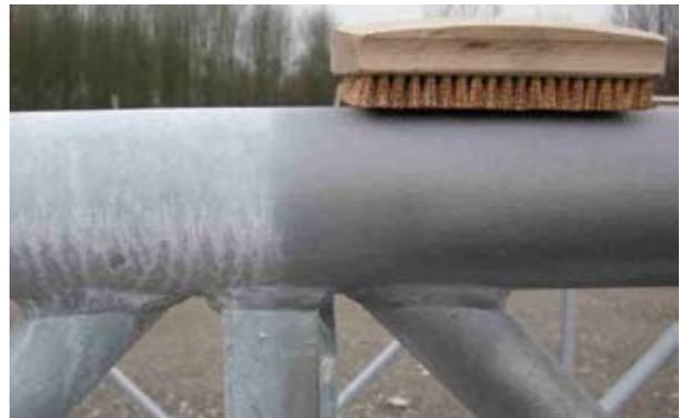
Die so gebürstete Oberfläche zeigt bei neuer Befeuhtung (Niederschlag, Kondenswasserbildung) in vielen Fällen keinen weiteren Befall mit Weissrost. Auch hartnäckiger, älterer Weissrost lässt sich teilweise entfernen.
