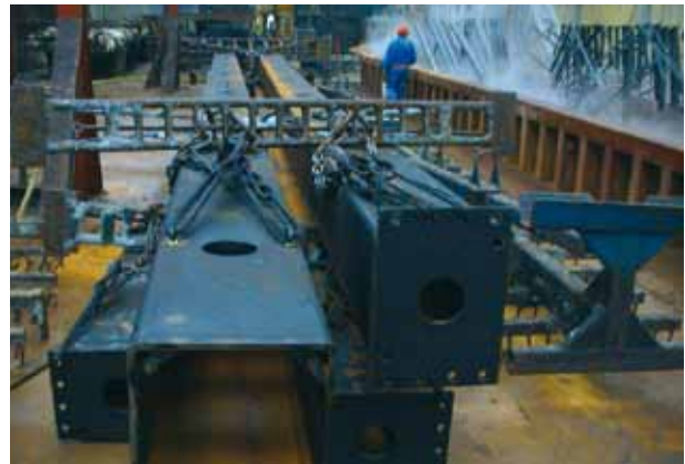
Spezielle Beizprozesse für höherfeste Stahlbauteile bei Galvaswiss
