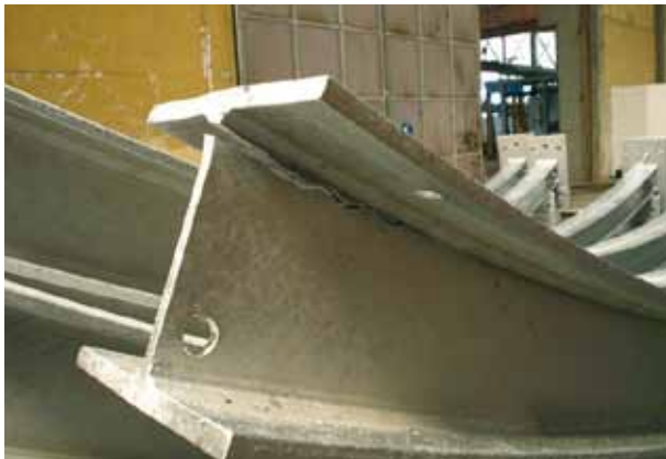
Sprödbruch an einem Träger. Ursachen können im Stahl, in der Stahlbearbeitung und/oder im Beizprozess liegen
