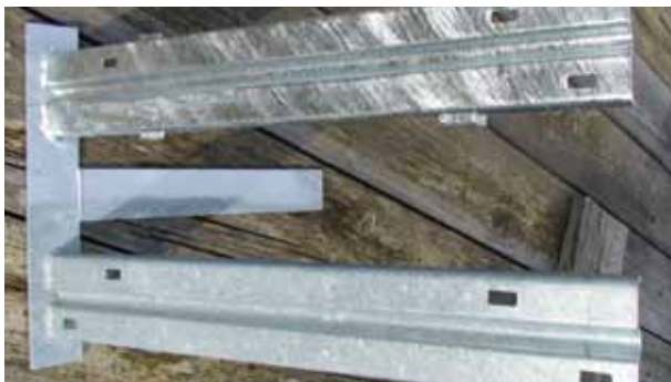
Wirkung von GalvaSeal nach 2 Wochen (oben appliziert, unten unbehandelte Feuerverzinkung nach 2 Wochen im Freien)
