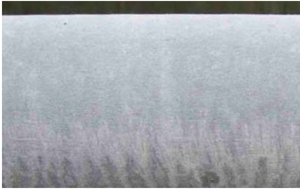
Bildung von Weissrost auf frisch verzinkter Ware nach Niederschlägen.
