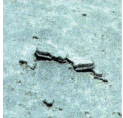
Schuppen und Schalen nach Feuerverzinkung in Blech St 52, Zinkschicht ca. 1000 µm
