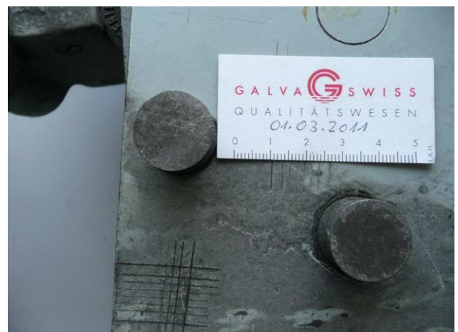
Gitterschnitt- und Haftzugprüfung an Prüfplatte Nr. 5, keine feststellbaren Veränderungen nach 18 Jahren
