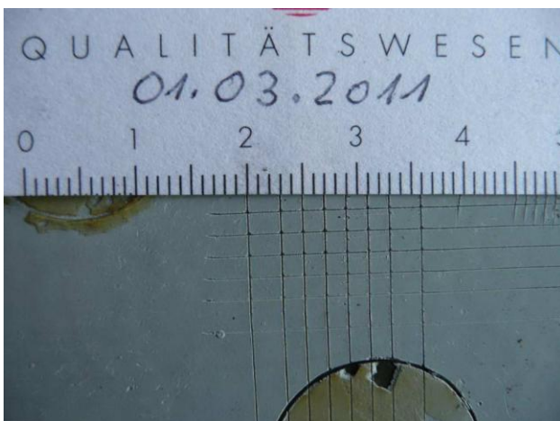
Gitterschnitt an der Prüfplatte Nr. 4, keine Veränderung nach 18 Jahren
