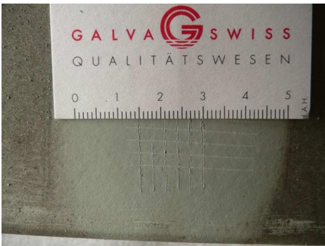
Gitterschnittprüfung nach Versuchsende an der Hängekonsole erfüllt den höchsten normativen Wert (Gt 0)
