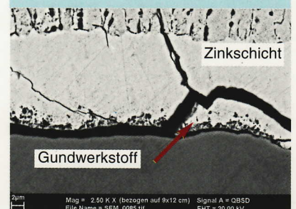
Bild 10: Geätzter Mikroschliff. BSE-Aufnahme an der lasergeschnittenen Kante im Bereich eines Schlagversuchs. Die Schichtabplatzung erfolgt am Übergang von der dunklen, eisenreichen Zone zum Grundwerkstoff (Pfeil).
