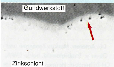
Bild 12: BSE-Aufnahme an der lasergeschnittenen Fläche der Versuchsserie E. Es sind erste Auscheidungen einer zusätzlichen Phase erkennbar (Pfeil).
