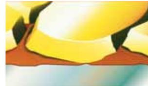
Beschichtung direkt auf Stahl: Rost unterwandert und sprengt Lack ab.
