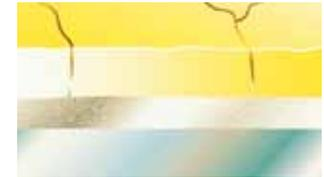
Duplex: Korrosionsprodukte des Zinks schliessen Risse.
