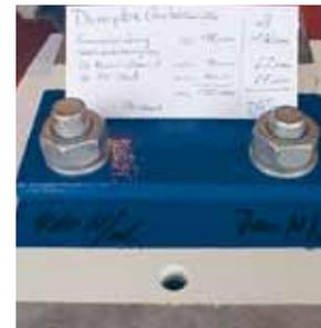
HV-Verschraubung mit 480 Nm (links) und 700 Nm (rechts): keine Aufwulstung.
