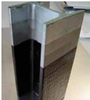
Bewährter Schichtaufbau Pulverlack im Erdbereich: Feuerverzinkung, sweepen (leicht strahlen), Epoxid-Grundierung, Polyesterdecklack, 2K-Teer-Anstrich.
