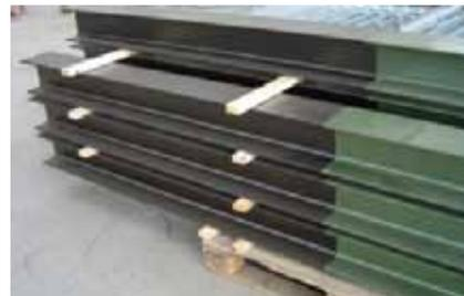
Verbauung an Autobahn: Duplex (Feuerverzinkung 85 µm + Pulverlack Epoxid-Grundierung 60 µm + Polyesterdecklack 60 µm), zusätzlich Teer-Anstrich (min. 300 µm) im Erdbereich.
